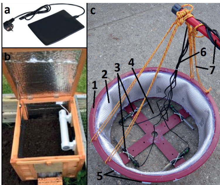
5. ábra: A lokális melegítés lehetséges eszközei: (a) fűtőpanel, (b) fűtőelemmel felszerelt szárazföldi búvóhely (Natassia Chacon fotója), (c) vízbe helyezhető készülék (1: meleg víz kiáramlását megakadályozó oldalfal, 2: hőszigetelés, 3: fűtőelemek, 4: ebihalak bejutását lehetővé tévő rés, 5: úszók, 6: elektromos kábelek, 7: készülék vízbe helyezését segítő felfüggesztés). (Az ábra eredeti közlése: Hettyey és mtsai. 2019)
